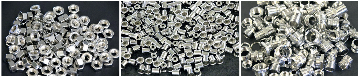
Abb. 1: Muster, die im Technikum mittels SAPHIR 2050 beschichtet wurden (alle Abb. Kiesow)
