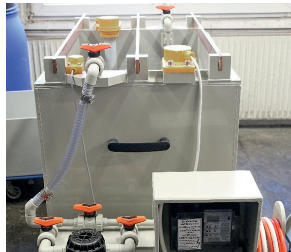
Abb. 3: Wanne für Trommelversuche direkt an der Anlage. Die Wanne ist mit einer Pumpe, Heizung und Ionentauschersäule ausgestattet
