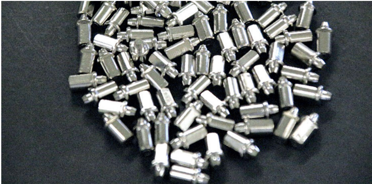
Abb. 2: Beschichtete Muster beim Kunden (20 A, 30 min., 52 °C). Es konnte eine Schichtdicke von 0,18–0,29 µm gemessen werden
